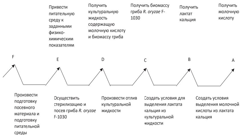
Рис. 2. Граф целей и задач технологического процесса получения молочной кислоты при культивировании гриба R. oryzae F-1030
