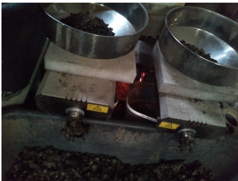
Рисунок 3. Получение жмыха из личинок черной львинки
